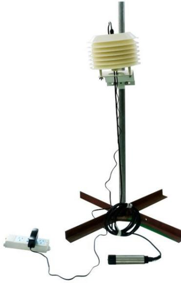
图三 RA0710Y 屏蔽罩内接浊度 Sensor (以实物为准)
